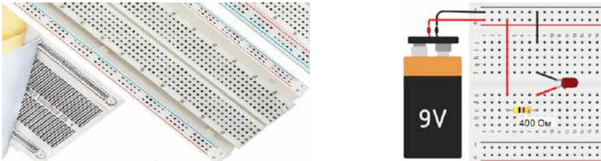
Рис. 8. Беспаячная макетная плата
