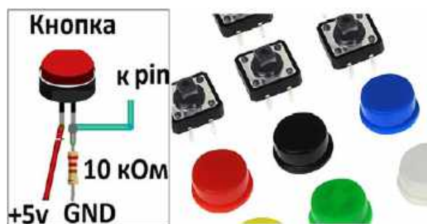
Рис. 1. Схема подключения тактовой кнопки к микроконтроллерной плате
