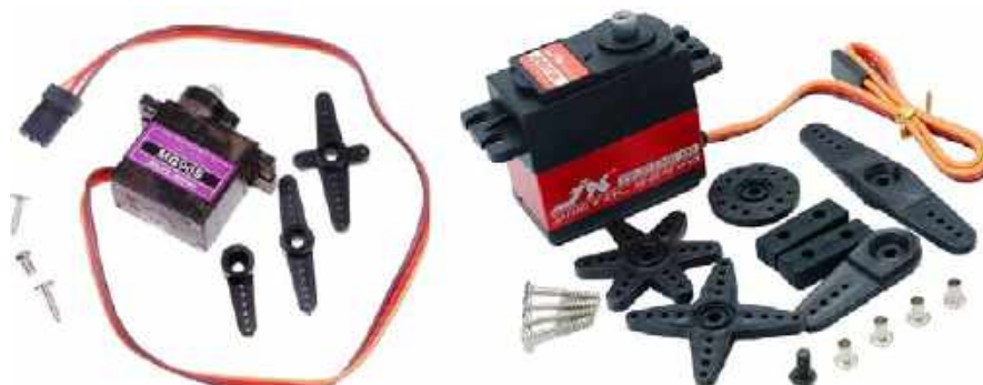
Рис. 19. Серводвигатели MG90S и PDI-6221MG-180
