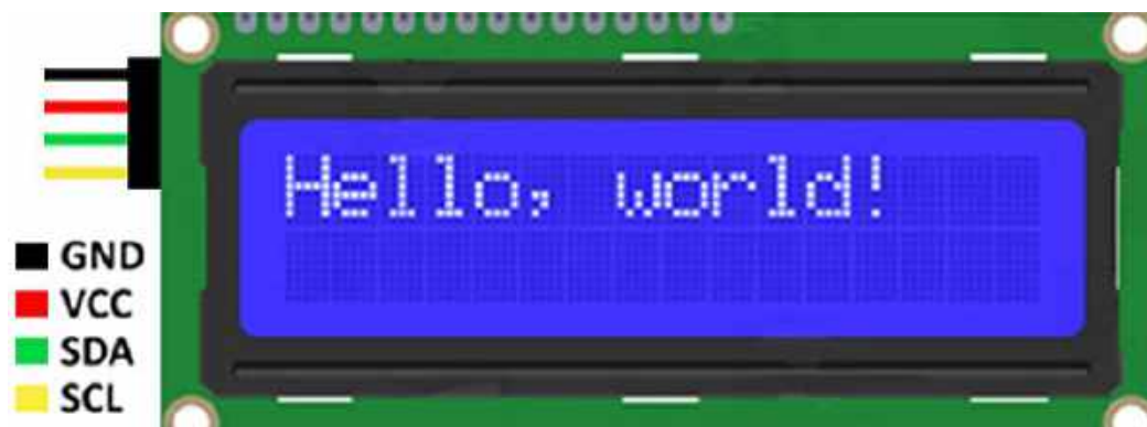
Рис. 1. Подключение модуля ЖКИ к Ардуино
