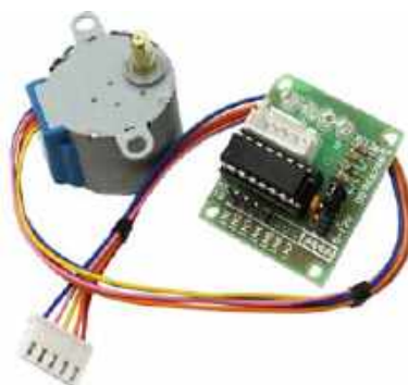
Рис. 20. Шаговый двигатель 28BYJ-48
