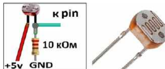
Рис. 4. Схема подключения фоторезистора к Ардуино
