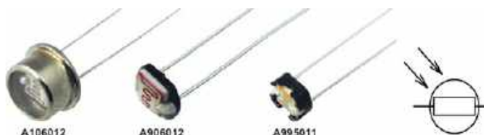
Рис. 12. Фоторезисторы и их обозначение
