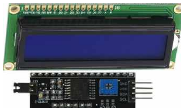
Рис. 17. Дисплей (жидкокристаллический индикатор — ЖКИ 16×2)
