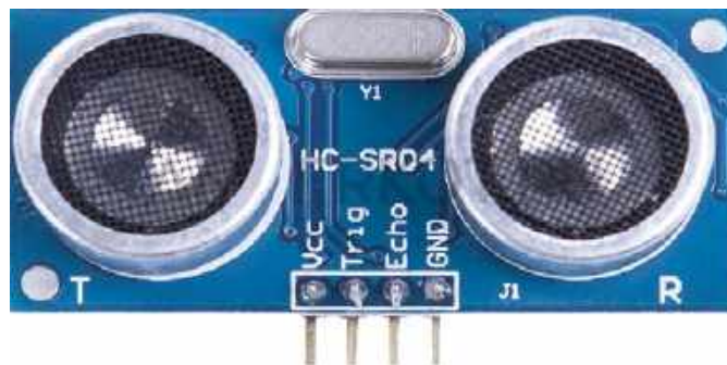
Рис. 16. Ультразвуковой датчик (дальномер)
