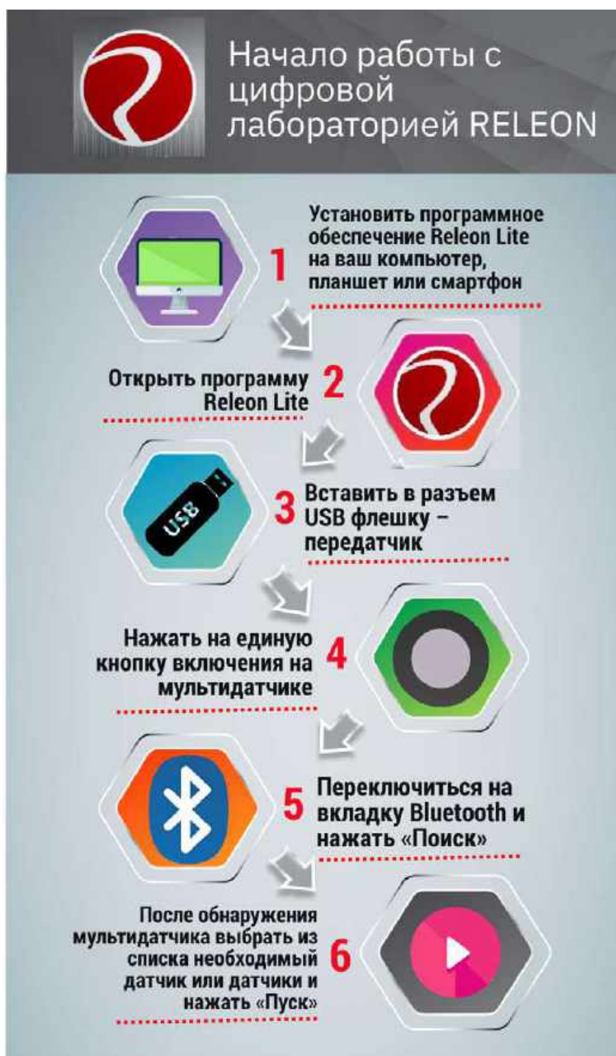
Рис. 14. Алгоритм работы с программным обеспечением Releon Lite
